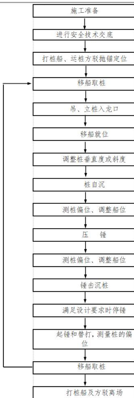
图 1.9.3-3 PHC 桩主要施工工艺流程
